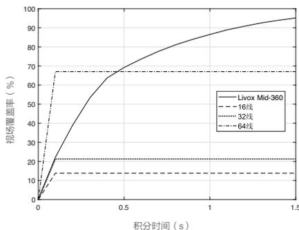
Mid-360 以及当前市场上常见的几种多线机械旋转式激光探测测距仪不同积分时间下的视场覆盖率
